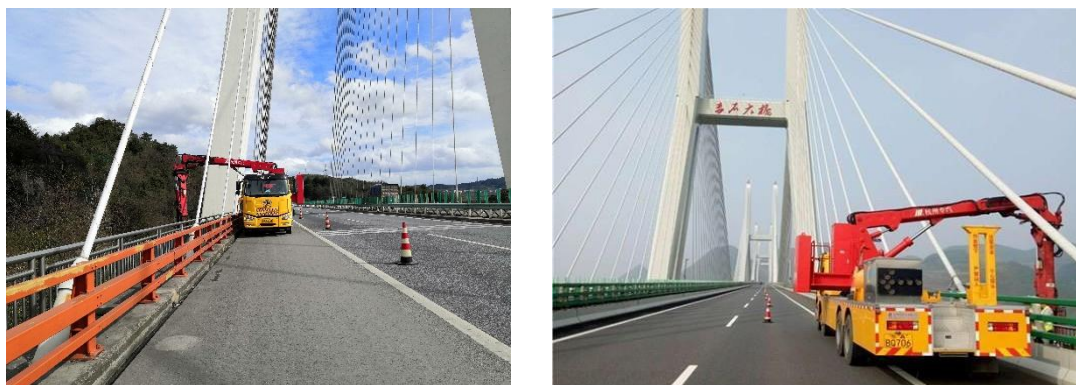
图 6.6 臂架式桥检车
