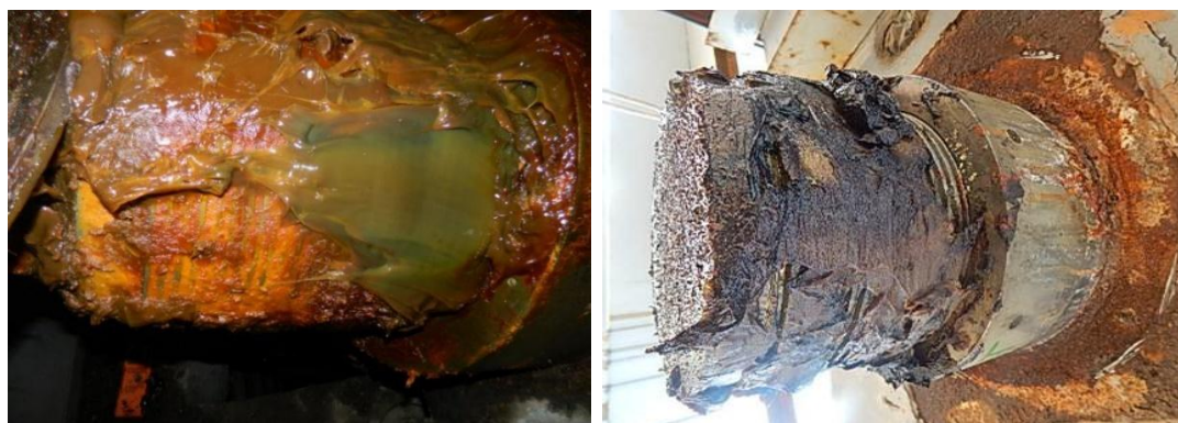
图 6.4 锚头密封失效积水，防腐材料变质，钢构件锈蚀
