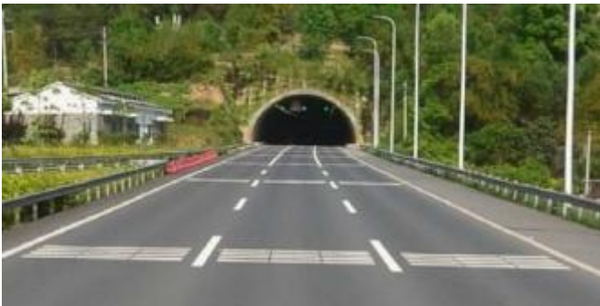
图 5-3 横向减速标线现场图
