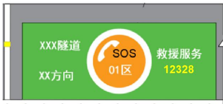
图 8-6 紧急停车带侧壁大图标救援标识
