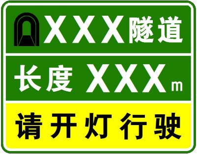
图 4-2 隧道信息标志版面示意图
