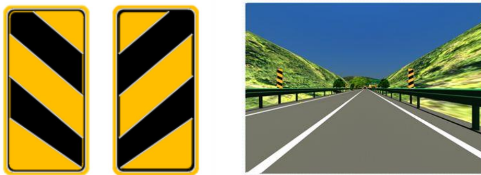
图 9-11 雾区警示型线形诱导标
