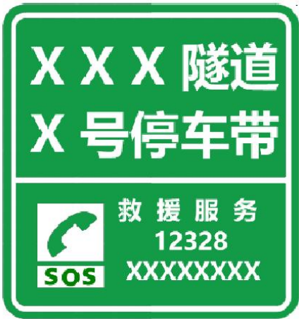
图 4-16 紧急停车带救援服务提示标志版面示意图
