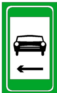
图 4-13 车行横通道指示标志版面示意图
