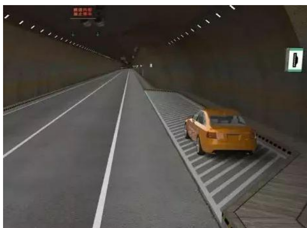
图 5-5 隧道紧急停车带标线示意图
