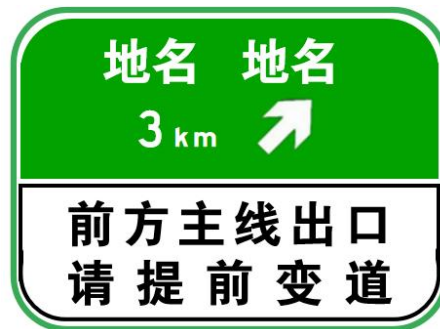
图 9-7 主线出口预告标志和提前变道提示标志版面示意图
