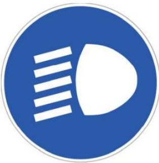
图 4-3 隧道开车灯标志版面示意图
