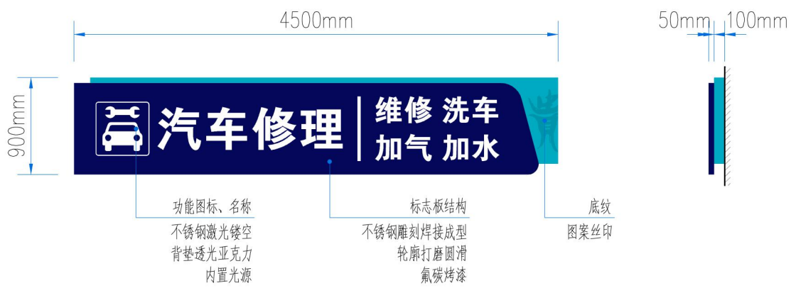
图 16 维修间标志（A3-2）示例
