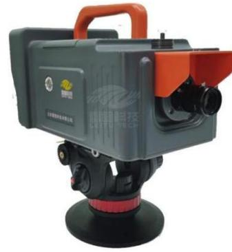
图 13 光电图像位移计
